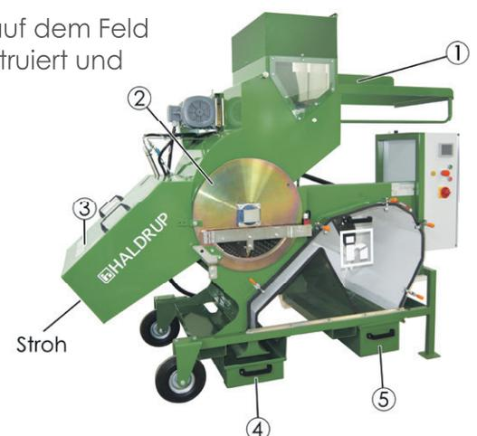
Beim Betrieb mit 2 Bedienern ist kontinuierlicher Arbeitsfluss in hoher Produktionsleistung möglich. Ein Bediener füllt ständig das zu dreschende Gut ein, der andere Bediener entleert kontinuierlich das ausgedroschene Saatgut (Box Nr. 4) und die Spreu (Box Nr. 5).
