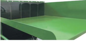
Extra breiter Einfülltisch von 640 mm für große Verarbeitungsmengen. Ebenso gibt es unterschiedliche Größen an Einfüllöffnungen.
