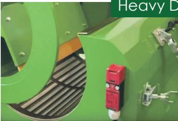
Die aus Stahl gelasert und behandelten Dreschkörbe mit einer Materialstärke bis zu 5 mm sind besonders langlebig und deshalb für den Dauereinsatz geeignet. Dreschkörbe mit Langloch sind ebenfalls erhältlich.
