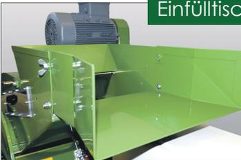
Über den Einfülltisch, der im Winkel verstellbar ist, wird das zu dreschende Gut der Dreschtrommel zugeführt. Die Einfülltische sind in unterschiedlichen Längen verfügbar.
