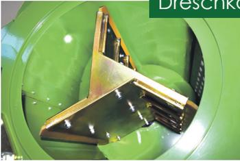
Perfekte Einsicht in den Dreschkorb und den Arbeitsprozess dank eingebauten LED-Hochleistungsbeleuchtung. Zur zuverlässigen und effizienten Qualitätsprüfung.
