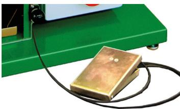
Um den Arbeitsprozess zu optimieren kann mit einem Fußpedal die Dreschtrommel-Bodenklappe bequem geöffnet werden!
