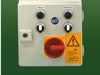
Die Gebläsegeschwindigkeit sowie die Drehzahl des Dreschwerks können stufenlos eingestellt werden.
