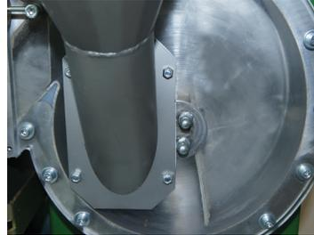
Durch die Klarsichtscheibe am Dreschwerk ist eine optimale Einsicht und genaue Kontrolle des gesamten Dreschvorgangs gewährleistet.
