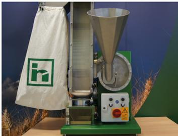
Staub, Spreu und Halmreste gelangen in den Spreusack. Alternativ kann eine Absauganlage angeschlossen werden.
